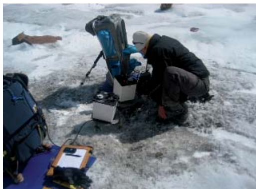
Abb. 15: Wissenschaftliche Mitarbeiter der Kommission für Erdmessung und Glaziologie der BAdW führen gravimetrische Messungen auf dem Vernagtferner durch. Ziel ist die Massenbilanzierung.
