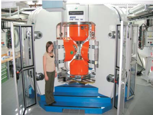
Abb. 10: Multianvilpresse des Bayerischen Geoinstituts an der Universität Bayreuth. Laborproben können mit dieser Einrichtung Drücken und Temperaturen wie im Erdmantel unterzogen werden.
