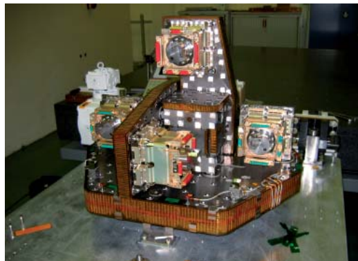
Abb. 6: Gravitationsgradiometer des Satelliten GOCE, bestehend aus sechs äußerst genauen Beschleunigungsmesssystemen.
