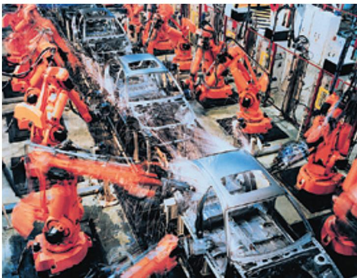
Abb. 1: In der Automobilindustrie werden Roboter schon lange beim Schweißen und Lackieren eingesetzt.
